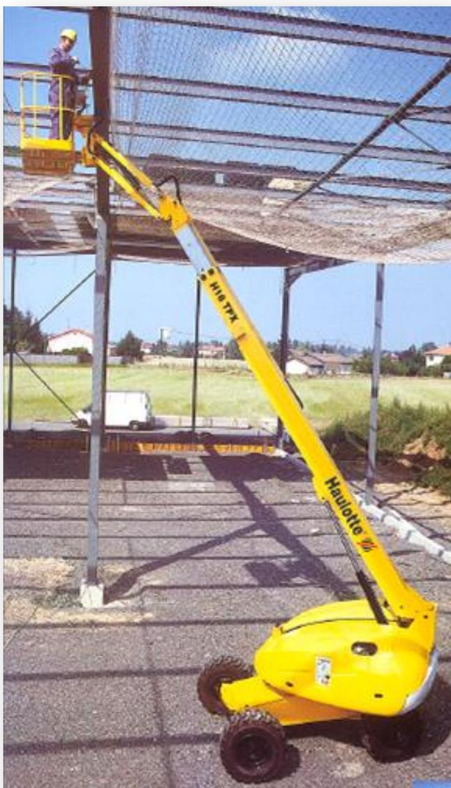
As plataformas telescópicas aplicam-se em situações onde o alcance é um factor determinante, dado que este é significativamente superior ao das articuladas. Podem ser giradas 360 graus num ou noutro sentido. O bloqueio diferencial mantém o poder igual a todas as rodas de tracção, mesmo que uma perca a aderência, devido às condições do terreno.
